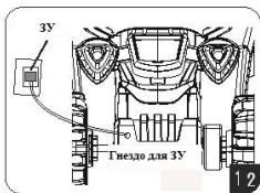
10. Использование зарядного устройства (ЗУ): гнездо для ЗУ находится в левой нижней части корпуса. Сначала вставьте ЗУ в электромобиль, затем подключите его к розетке.
