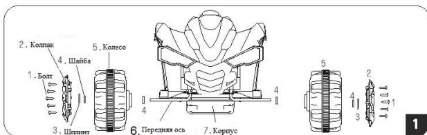
1. Переднее колесо и колпак: вставьте шайбу с двух сторон передней оси, затем наденьте колеса. Затем вставьте шплинт в отверстие в оси. Наденьте колпак.
