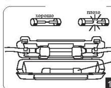
9. Для замены предохранителя достаньте его из корпуса электромобиля (он находится под сидением), затем откройте корпус предохранителя и замените рабочий элемент.
