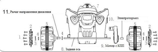
2. Заднее колесо и колпак: вставьте заднюю ось в корпус электромобиля, затем наденьте на нее мотор, электротормоз, заднее колесо и шайбу. Затем вставьте шплинт в ось.
