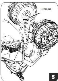
3. Установка рулевой рейки и руля: переверните корпус электромобиля, вставьте рулевую рейку в пазы 1 и 2 (см. рисунок 3). Затем наденьте руль на конец рулевой рейки (см. рисунок 4), затяните гайку на руле. В конце наденьте шайбу на рулевую рейку и вставьте шплинт (см. рисунок 5).
