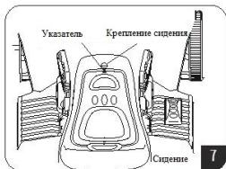
5. Сборка сидения: когда указатель замка направлен на стрелочку, Вы можете снять сидение.
