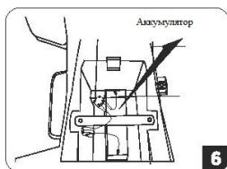
4. Аккумулятор: с помощью отвертки открутите болты с крышки аккумулятора, подсоедините его. Затем прикрутите назад крышку аккумулятора и установите сидение.
