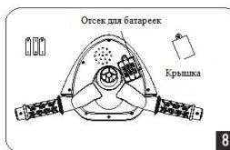
6. Батарейки: приобретите 3 батарейки AAA 1,5В и вставьте их в отсек на руле (см. рисунок 6).
