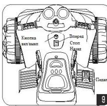
7. Управление: Нажмите на кнопку Вкл/выкл, затем кнопку «Вперед/стоп/назад» до позиции , нажмите на педаль, электромобиль поедет вперед. Когда кнопка стоит в позиции , электромобиль поедет назад. Как только Вы отпустите педаль, электромобиль остановится.
