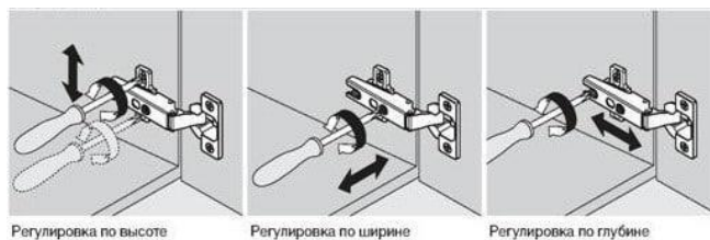
Схема регулировки дверных петель
