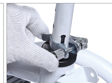
14. Закрепите болты и фиксатор
