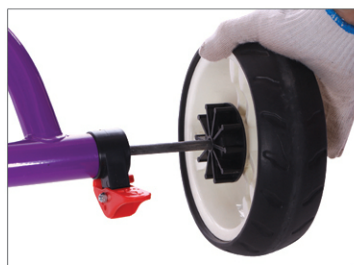
8. Задняя ось проходит через колесо и крепится на раму
