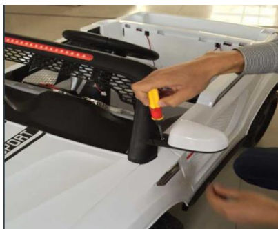
9. Закрепите лобовое стекло с помощью болтов M5x20
