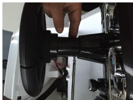
8. Установите рулевое колесо на рулевой вал, закрепите болтом и гайкой
