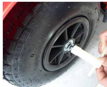
3. установите шайбу и гайку На переднюю ось с помощью ключа (также со всеми колесами)
